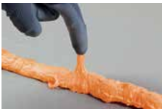
Attendre jusqu'à la formation de fil (1 à 5 min)
